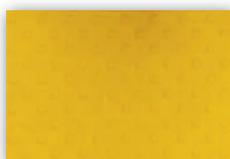
Costituito da una piastrella in M-PVC-P delle dimensioni 40x60 cm recante delle calotte sferiche disposte a reticolo diagonale indicante una situazione di arresto/pericolo.
