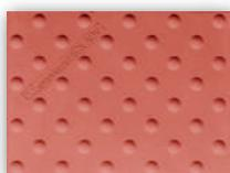
Costituito da un'unica piastrella 30x40 cm in gres porcellanato recante delle calotte sferiche disposte a reticolo diagonale indicante una situazione di arresto/pericolo.
