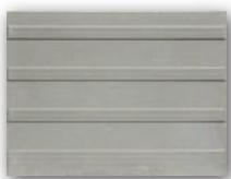
Costituito da due elementi 30x40 cm in calcestruzzo vibrocompresso che accoppiati formano una larghezza del percorso di 60 cm dotato di scanalature parallele al senso di marcia indicante la direzione rettilinea.
