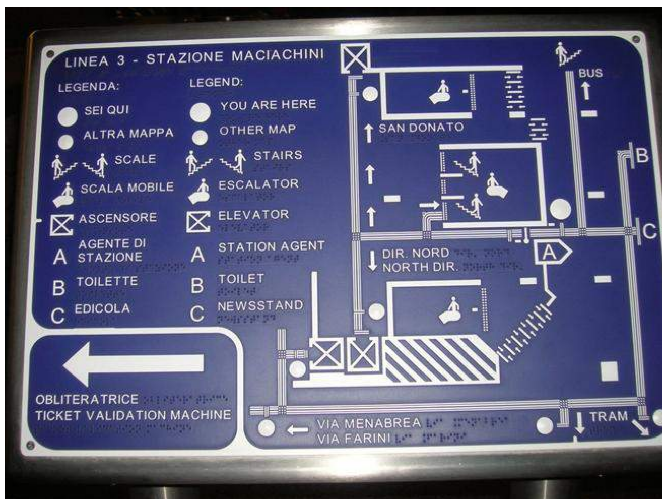
Foto n. 2 - Mappa non conforme al disciplinare (Milano Metro 3). Sono presenti disegni a rilievo non riconoscibili al tatto.
