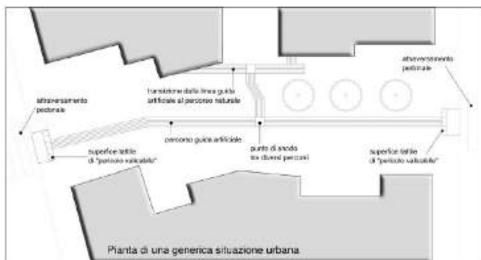
Disegno n. 1 – Situazione in cui deve essere realizzato un “percorso guida artificiale” a causa della non linearità della muratura del fabbricato che non costituisce una valida guida naturale.
